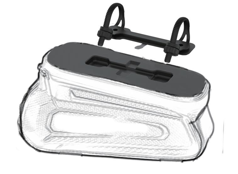
公扣通过螺帽收紧尼龙带固定在车架上,这样磁吸可以快速的安上车包,拉动手柄可快速取下车包。
